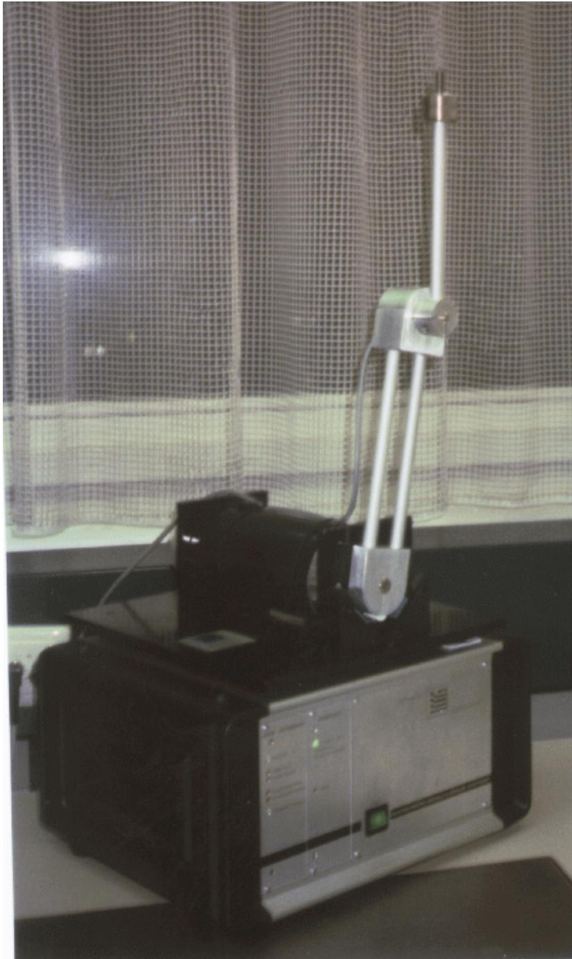
Abbildung 15: Pendelsystem mit Steuergerät
